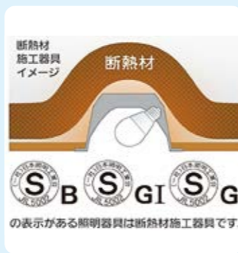
断熱施工対応型のLED電球が必要
