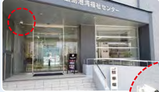
▲表正面玄関の天井面に 屋外用カプセルカメラ を設置しました。昼間はカラーで夜間真っ暗になると白黒で赤外線照射します。
