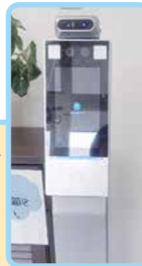
適正な体温でない時は「体温を確認してください」と音声と赤いランプで知らせてくれます。
